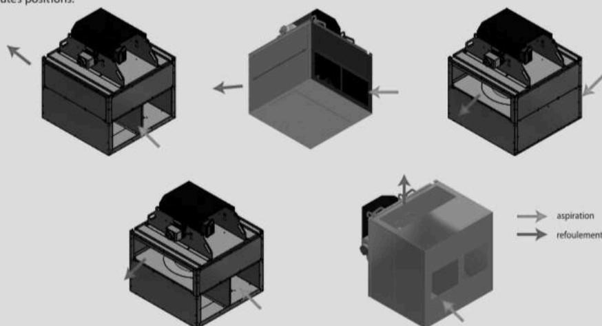
Seules les installations présentées sont conformes. Le montage axe horizontal est autorisé, jusqu'à la taille 9 000.
